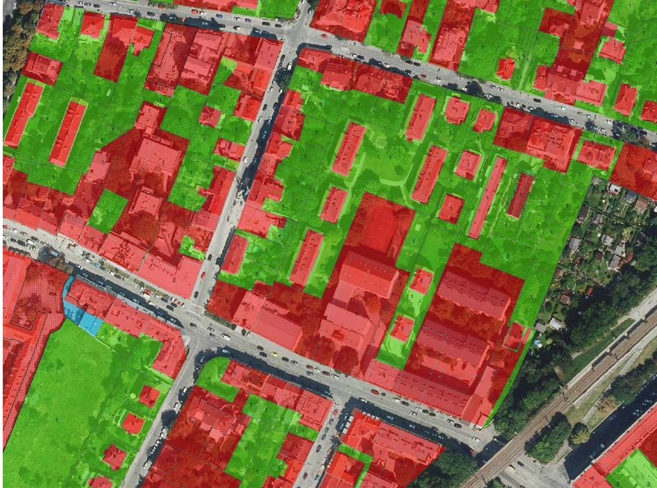
*Abbildung 5: Gebäudeparzellen in Wien, die in der DKM nicht durch einen vorangestellten Punkt als solche gekennzeichnet sind*
